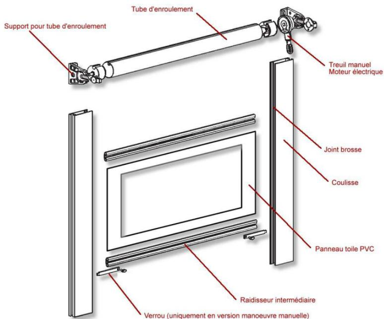
La fixation des supports de tube d'enroulement se fait à l'aide de vis de 8mm de diamètre, adaptées au type de matériaux sur lequel ils seront fixés (vis non-fournis).
