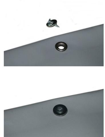
Ce sont de simples œillets en inox de diamètre intérieur 8mm vous permettant de visser directement la bâche sur son support au moyen d'une vis et d'une rondelle (**non fournis**). C'est le mode de fixation le plus solide.
