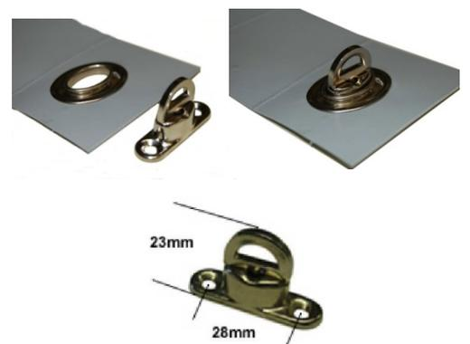
Des œillets ovales sont posés sur la toile, des tourniquets vous sont fournis et sont à visser sur votre support (**vis non fournies**). La fixation se fait en enfilant l'œillet sur le tourniquet, puis une rotation de ce dernier verrouille l'ensemble.
