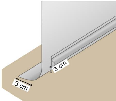
Pour la finition basse de votre fermeture de terrasse nous vous proposons en plus des autres types une finition composée d'une bavette de 5 cm reposant sur le sol ainsi qu'un fourreau soudé à 3 cm du bas du côté de terrasse permettant d'accueillir un tube en métal **(non fourni)** afin de rigidifier le bas de la bâche.
